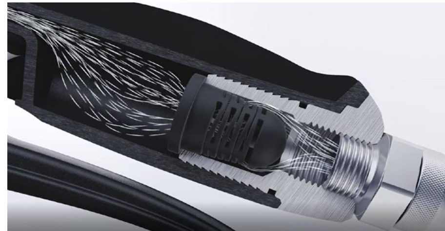
Az adagoló kar behúzva - a sűrített levegő áramlik (2)
